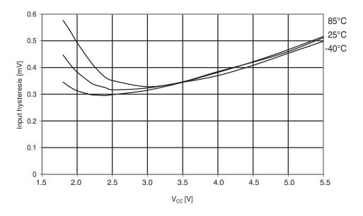
Figure 29-174.Atmel ATmega324PA: I/O pin input hysteresis vs. V<sub>CC</sub>.
